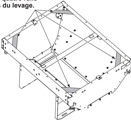
4. Centrer l'épandeur d'un côté à l'autre. Déplacez l'épandeur vers l'avant ou l'arrière jusqu'à une position qui permettra à la goulotte, une fois installée, de surplomber l'arrière du véhicule et le pare-chocs. Avec deux autres personnes, essayez de monter la goulotte pour vérifier le dégagement.
