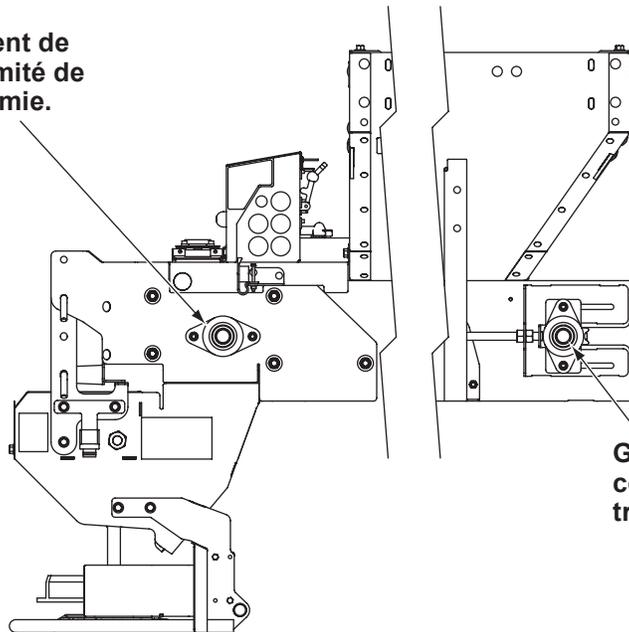
Graisser les roulements côté conducteur et côté trottoir.
