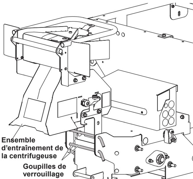
3. Faites tourner l'ensemble d'entraînement de la centrifugeuse vers le haut et fixez-le en position relevée en réinsérant la goupille de verrouillage dans le trou *supérieur* des supports de la goulotte et de l'ensemble d'entraînement de la centrifugeuse.
