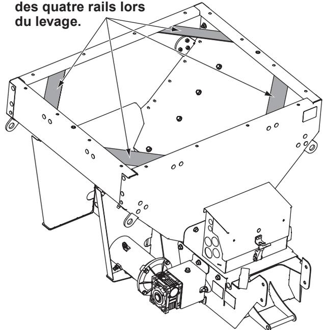
5. Centrer l'épandeur d'un côté à l'autre. Déplacez l'épandeur vers l'avant ou l'arrière jusqu'à une position qui permettra à la goulotte, une fois installée, de surplomber l'arrière du véhicule et le pare-chocs. Avec deux autres personnes, essayez de monter la goulotte pour vérifier le dégagement.
