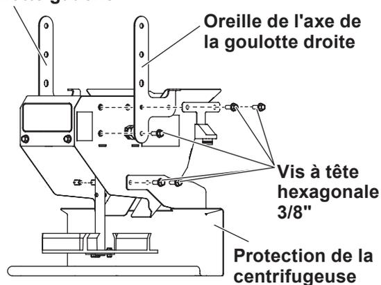
3. Mettez la goulotte de côté pour l'installer après avoir installé l'épandeur sur le véhicule.
