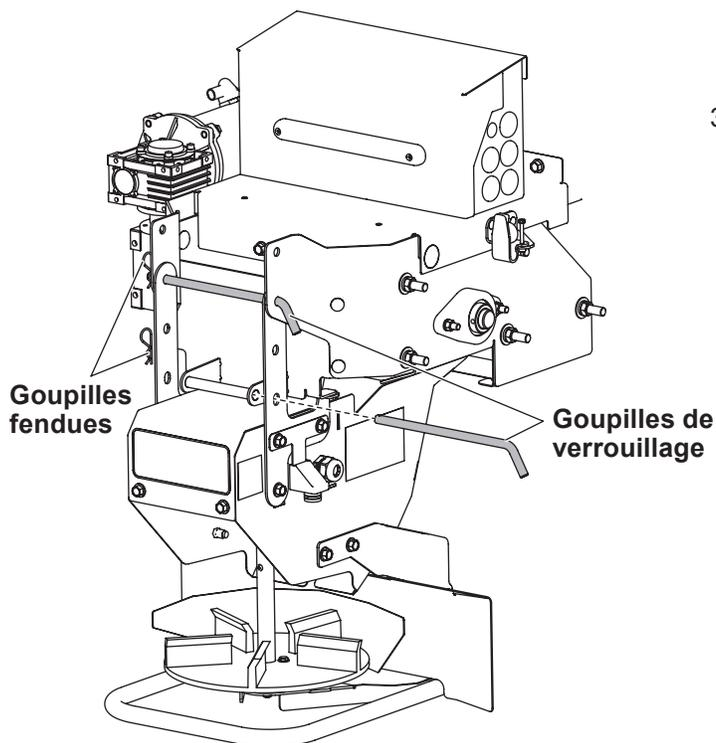
2. Fixez l'ensemble d'entraînement de la centrifugeuse à l'épandeur à l'aide des goupilles de verrouillage de la boîte de pièces. *Installez d'abord la goupille de verrouillage supérieure.*
